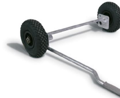
Wenn Sie mit Ihren CC-Containern unwegsame und weiche Böden befahren wollen, sollten Sie Ihre Geräte mit Lufträdern ausrüsten. Wir bieten ein einfach zu handhabendes Stecksystem. Die Achse wird in das Fahrgestell eingesteckt und ist somit fest arretiert. Die dann mittig am Wagen angebrachte Achse macht den Container außerdem sehr wendig und leicht beweglich.
